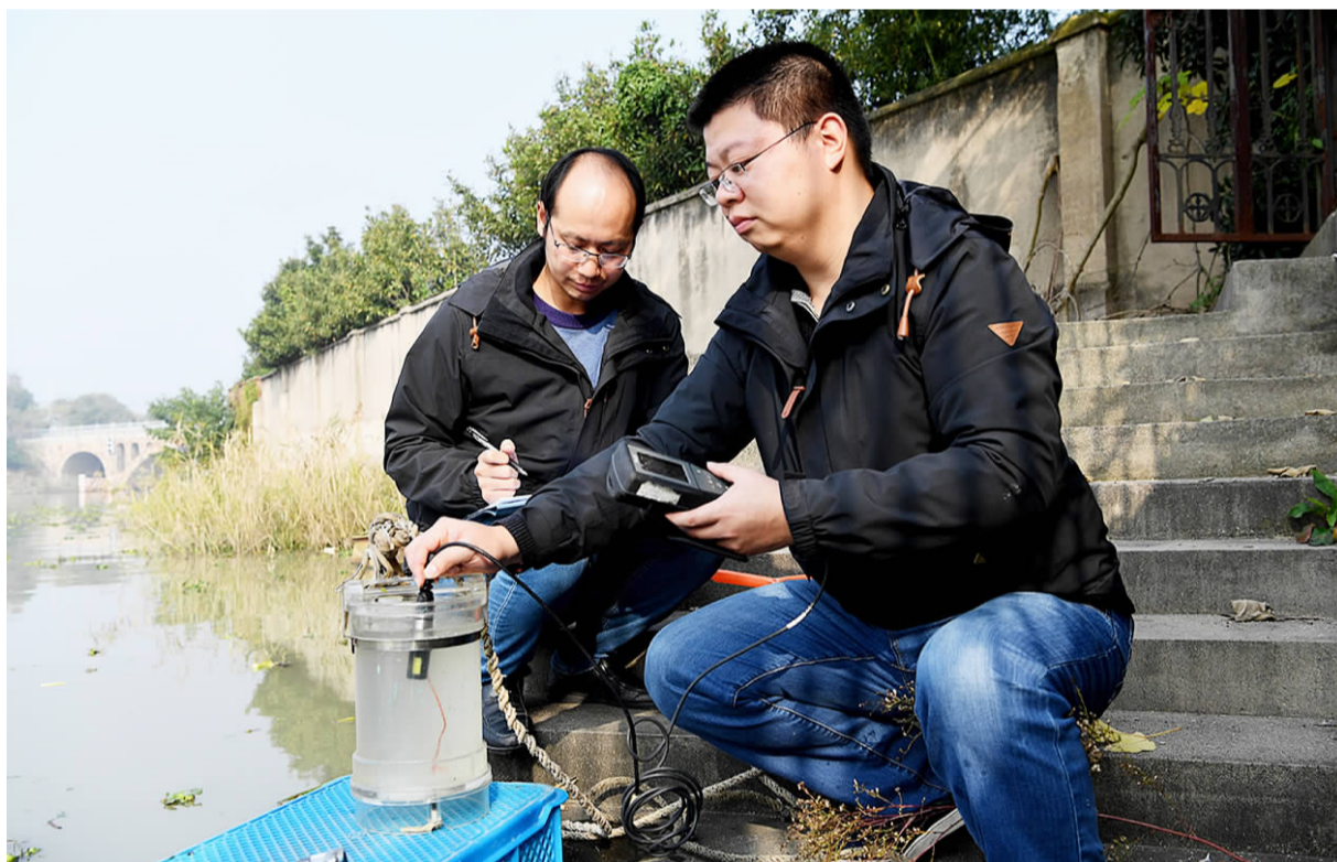
日前,我区对直湖港、武进港、雅浦港三条进入太湖的河流断面进行枯水期水质预警监测,监测项目包括水温、pH 值、溶解氧、高锰酸盐指数、氨氮、总磷、总氮、挥发酚、流向等,以全面掌握枯水期的水质状况,为大湖水环境整治提供科学参考数据。图为环保监测人员在入湖河道直湖港边监测水质。 拂子 摄
